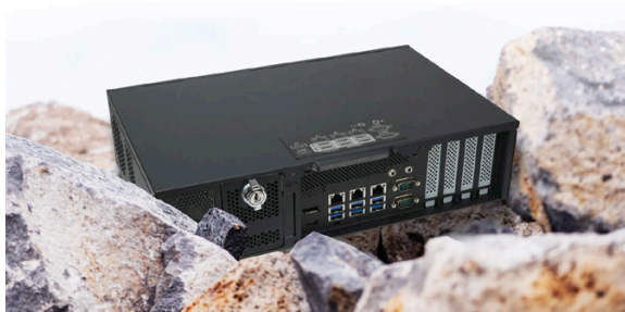
Počítač splňuje odolnost danou armádní normou MIL-STD-810G.
